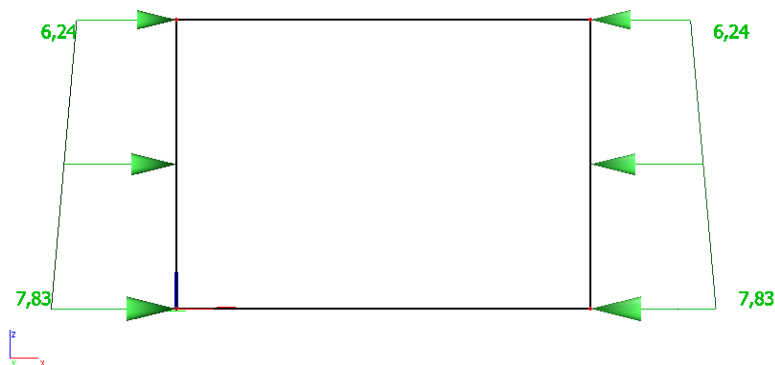
Figure 5 : Poussée des terres ( P_{\text{terres}} en \text{t/m}^2 )
