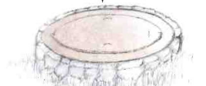
Reprise de la maçonnerie sans sur-élévation, assemblage des pierres et jointements à la chaux. Mise en place d'un capot étanche.
