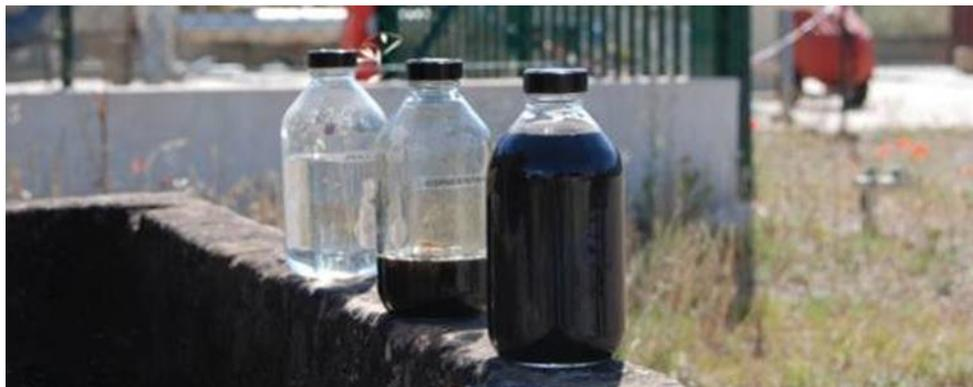
**Figure 35. Du plus proche au plus éloigné : lixiviat ; concentrat, perméat**
