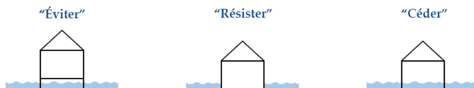
Figure 22: Illustration des logiques de stratégie de prévention en zone bleue (source CEPRI – [41] )
