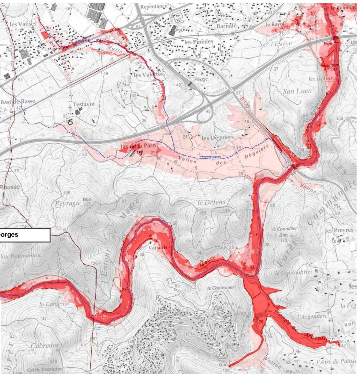
Figure 25 : Hauteur d'eau et vitesses d'écoulement – L'Argens et Quartier des Valises
