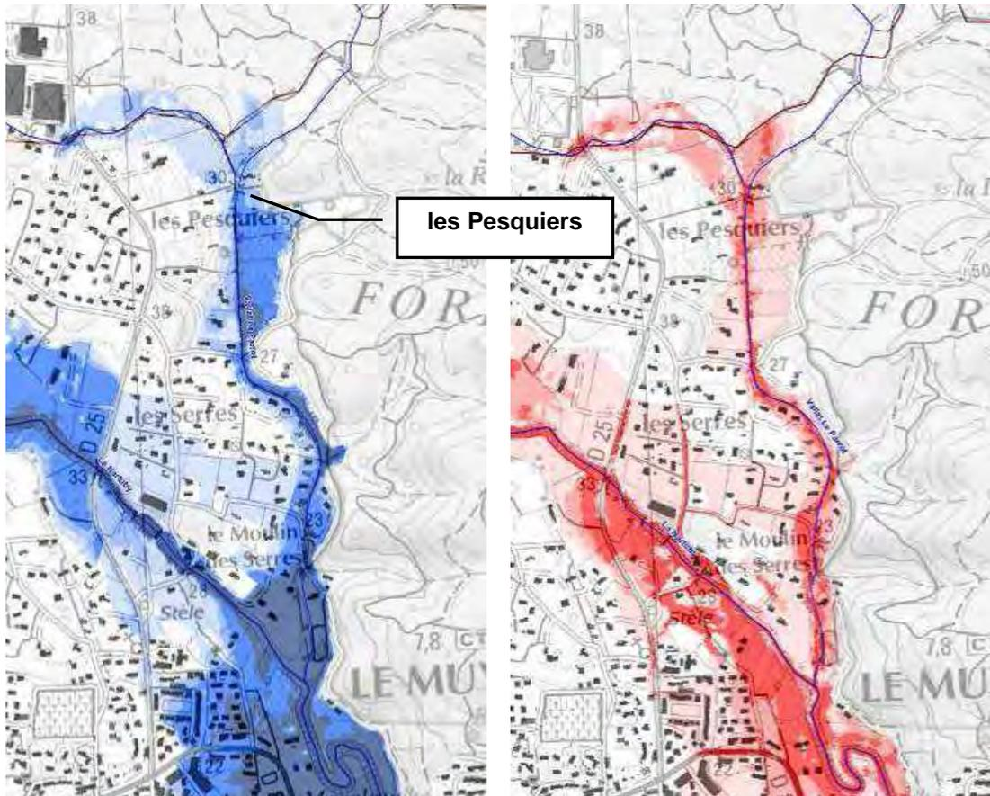
Figure 24 : Hauteur d'eau et vitesses d'écoulement – Le Parrot
