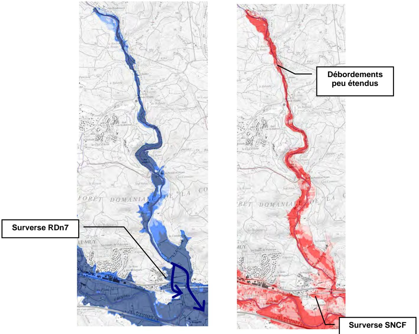
Figure 26 : Hauteur d'eau et vitesses d'écoulement – L'Endre
