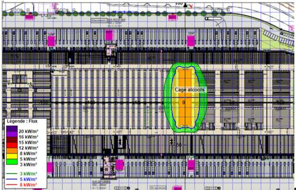
Figure 15 : Cartographie des flux thermiques – cage alcools
