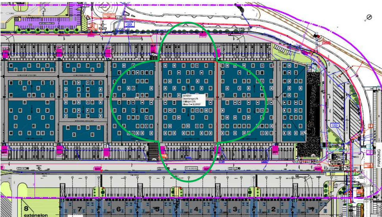
Figure 6 : incendie de la cellule 3 (pondération des stockages)
