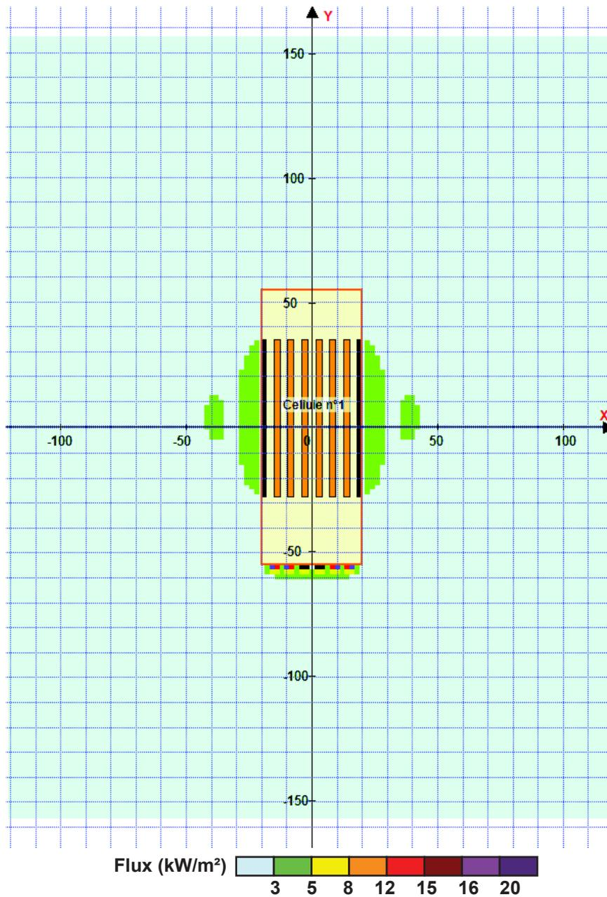
Pour information : Dans l'environnement proche de la flamme, le transfert convectif de chaleur ne peut être négligé. Il est donc préconisé pour de faibles distances d'effets comprises entre 1 et 5 m de retenir une distance d'effets de 5 m et pour celles comprises entre 6 m et 10 m de retenir 10 m.
