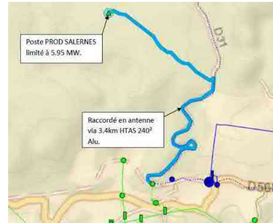
Schéma simplifié indicatif de raccordement – Source ENEDIS
