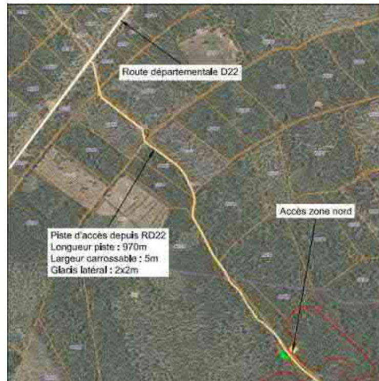
Voie d'accès à la centrale
