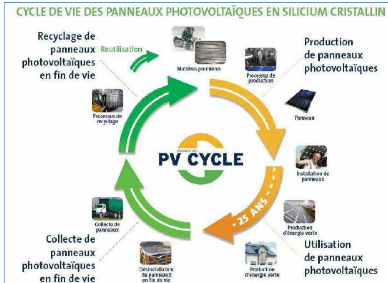
Figure 30 : Cycle de vie des panneaux photovoltaïques en silicium cristallin
