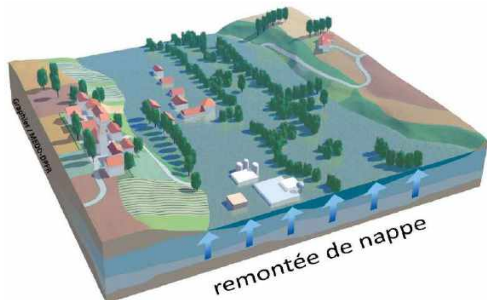
Figure 14 : Le phénomène d'inondation (Source : georisques.gouv.fr)
