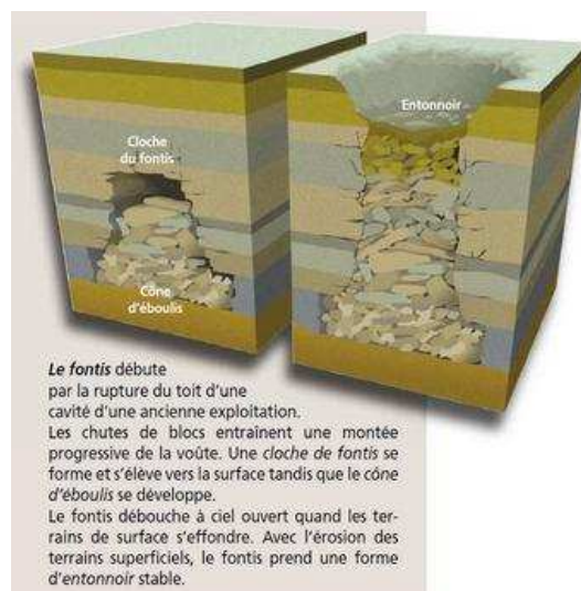
Illustration du phénomène d'effondrement localisé
