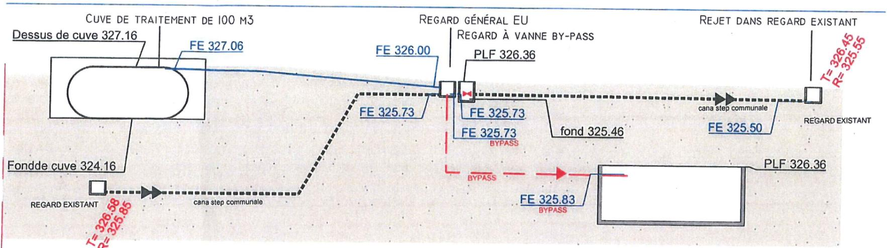
Synoptique du reseau pression du traitement phytosanitaire jusqu'à la cuve
