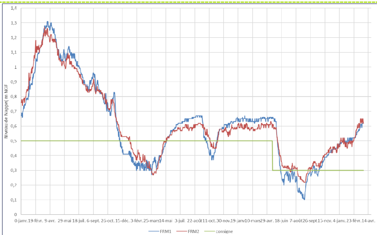
Figure 10. Suivi piézométrique – Ligne P2 – Nappe de la Ferme
