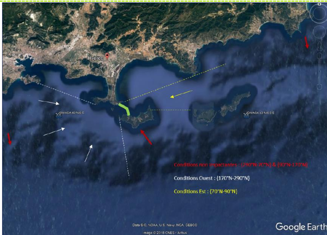
Figure 88. Secteurs d'incidence sur le site d'étude (Source : OCEANIDE)
