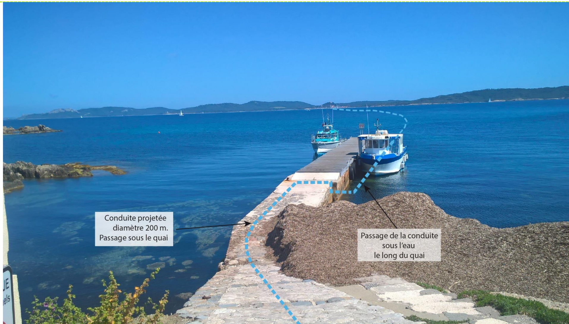
Figure 176. Perceptions depuis la terre sur le passage de la canalisation : côté Giens
