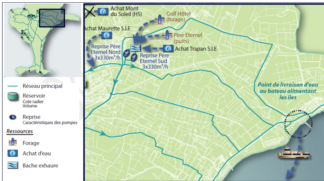
Figure 15. Synoptique de l'alimentation en eau des barges
