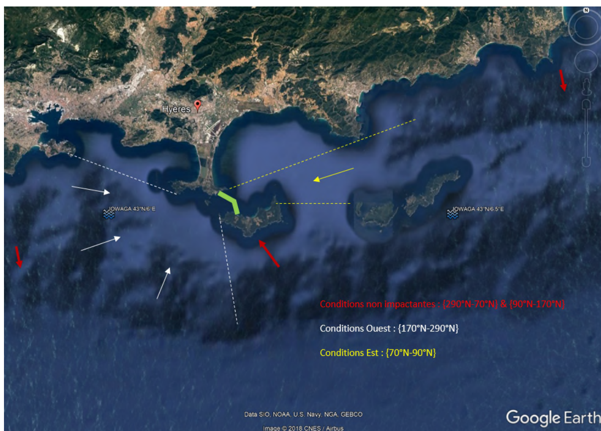
Figure 3-11 : Secteurs d'incidence sur le site d'étude
