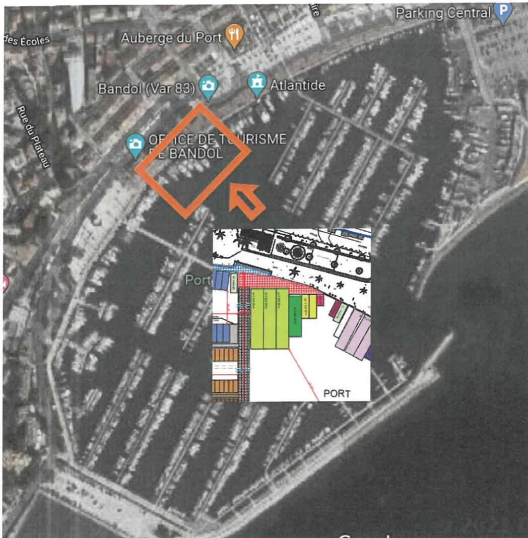
La panne touristique sera raccourcie et réalignée sur l'orientation de l'actuelle panne D. Cela permettra de libérer le chenal d'accès ouest. Cela permettra également d'envisager une reconfiguration du plan de mouillage de la partie ouest de la grande jetée dont l'accès est également libéré par la disparition de l'actuelle partie flottante de la panne touristique.
