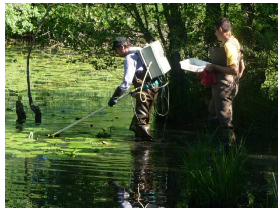
Pêche électrique à l'aide d'un engin portatif de type « martin-pêcheur » (source : Onema)
