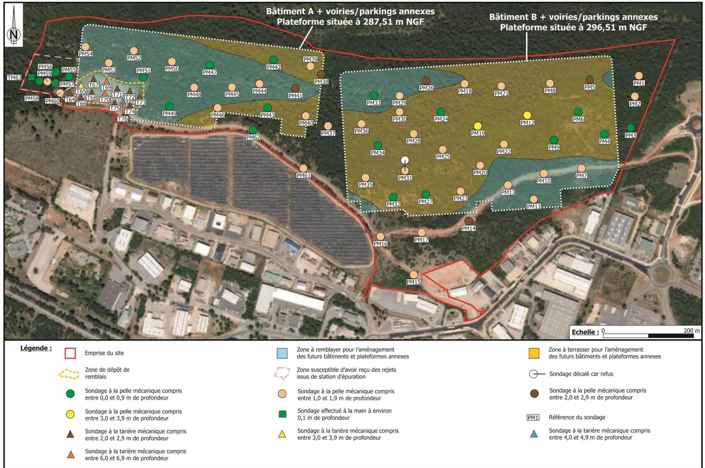
Figure 34 : Plan d'implantation des sondages
