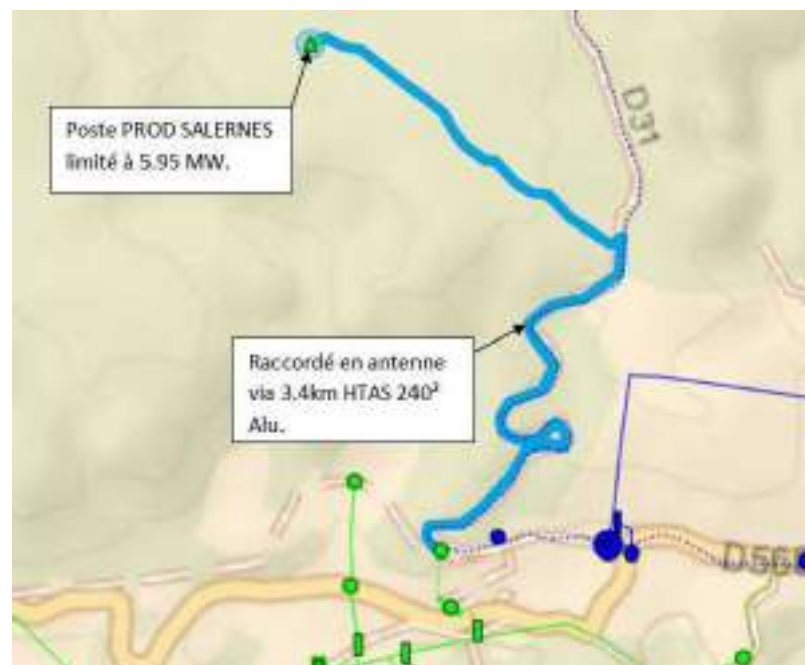
Schéma simplifié indicatif de raccordement – Source ENEDIS
