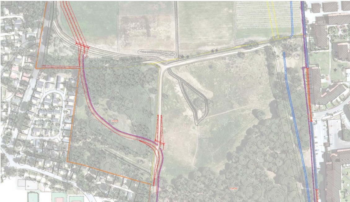
Figure 9 : Adaptation du tracé de la digue aux enjeux environnementaux.
