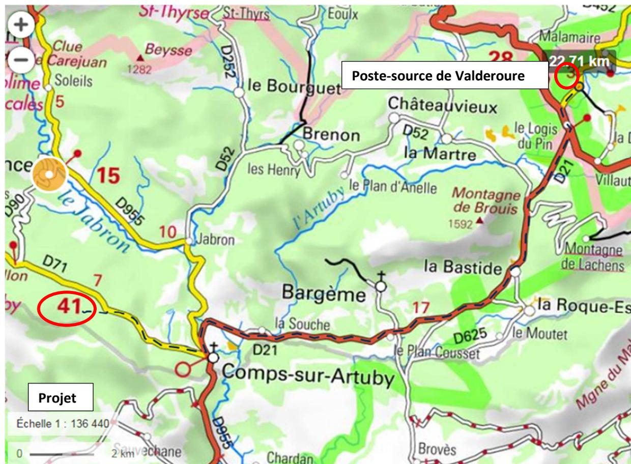
**Figure 1 : Tracé du raccordement prévisionnel du parc solaire sur le poste électrique de Valderoure**
