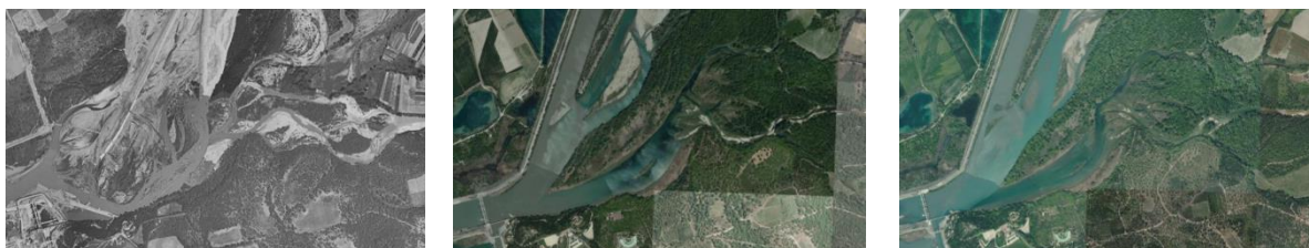
Evolution de la morphologie du Verdon et de la confluence avec la Durance entre 1958, 2000 et 2015 suite à la mise en place du barrage de Cadarache en 1963 en aval de Vinon-sur-Verdon
