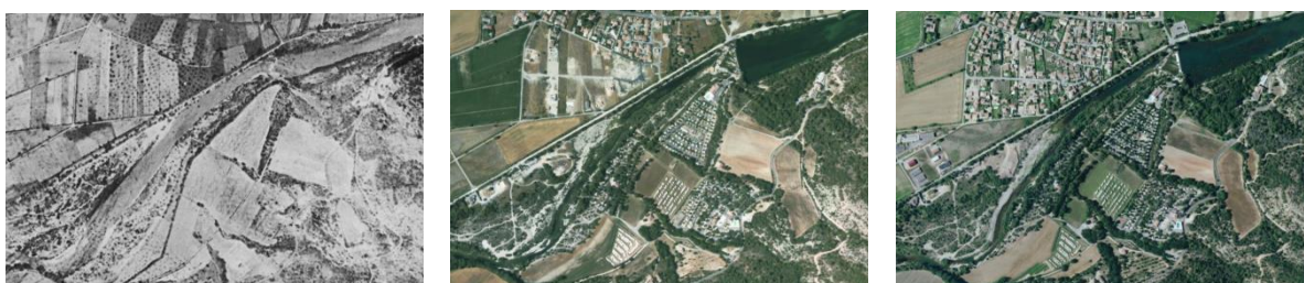
Evolution de la morphologie du Verdon entre 1958, 2000 et 2015 suite à la mise en place du barrage de Gréoux en 1967 en amont de Vinon-sur-Verdon
