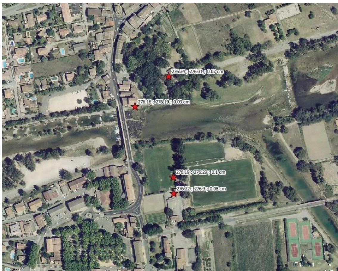
Figure 15 : Comparaison entre les niveaux d'eau du modèle et les PHE de la crue de 1994
