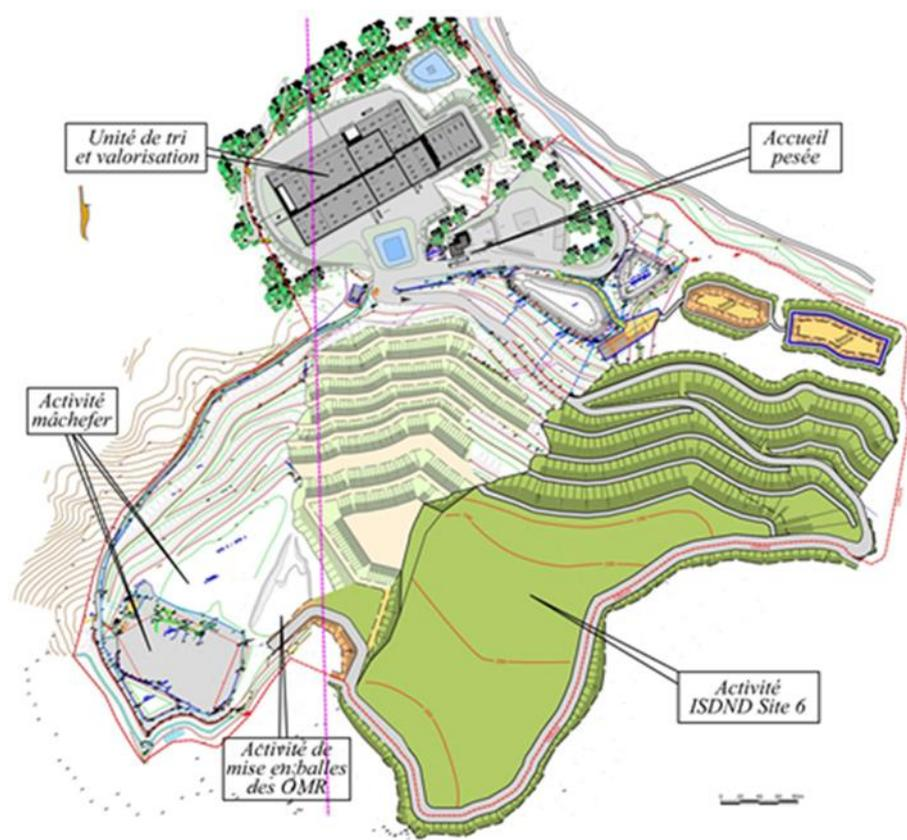
**Figure 53. Emplacements des installations projetées (nouveau casier de stockage des DND : site 6 et UTV) et existantes**
