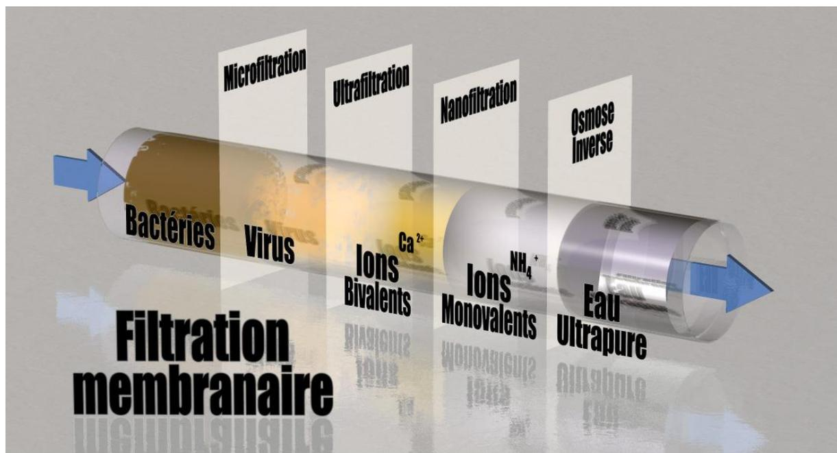
Figure 37. Les techniques de filtrations membranaires
