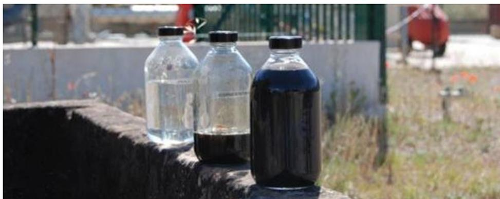
**Figure 38. Du plus proche au plus éloigné : lixiviat ; concentrat, perméat**
