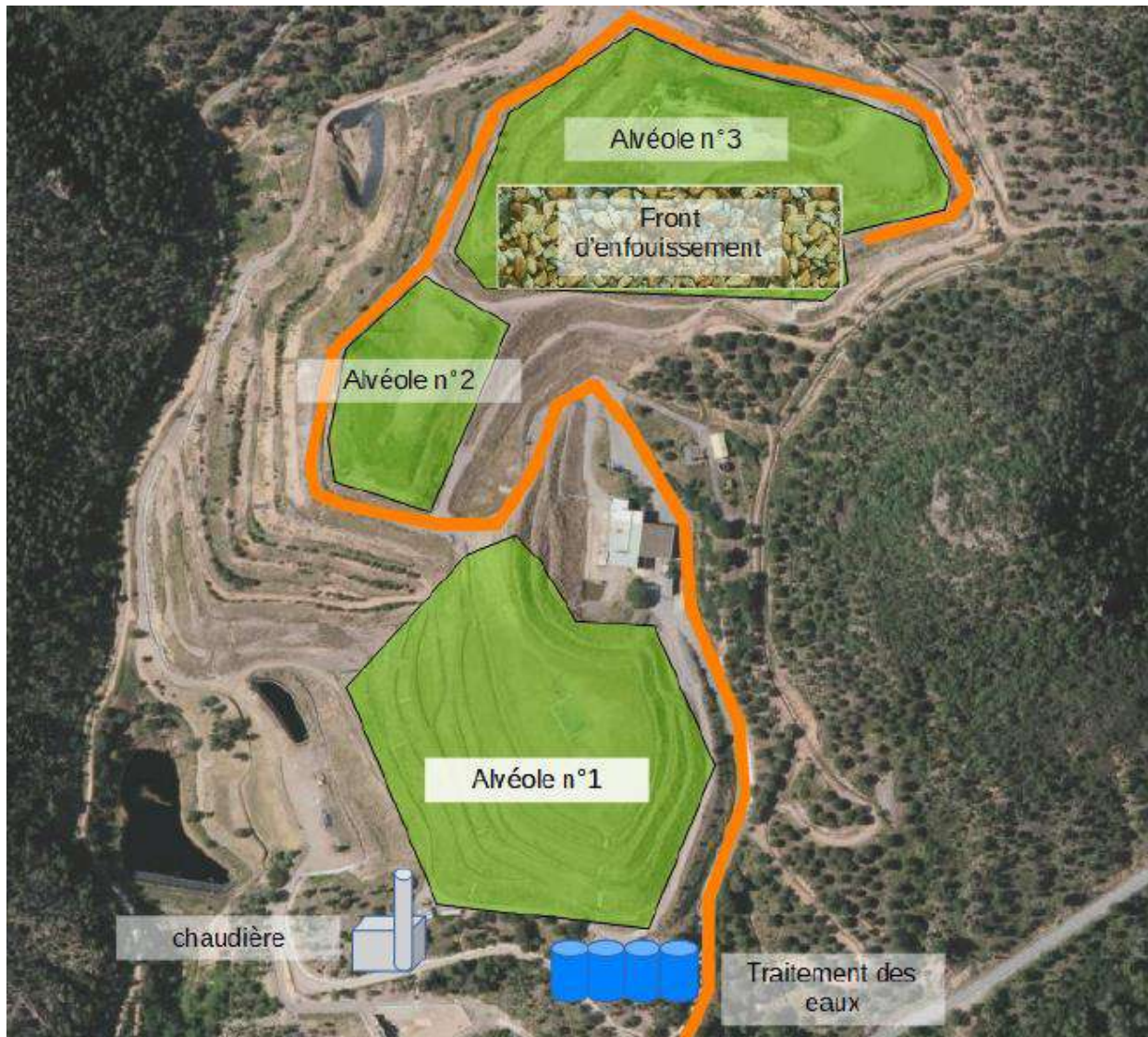
Schématisation des zones auditées au cours de la déambulation du 27 janvier 2020 sur le site de l'ISDND des Lauriers. Le cliché relativement ancien ne rend pas compte de la végétalisation des deux premières alvéoles. Le tracer orange correspond au chemin de circulation des véhicules sur le site, emprunté pour la déambulation. Source : Rapport d'étude OLENTICA (février 2020).
