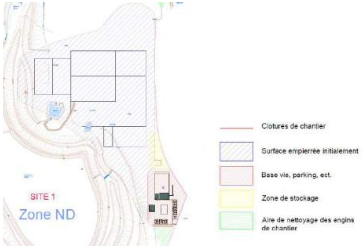
Schéma de principe de l'organisation du chantier. Extrait du mémoire relatif à l'ouvrage, iHOL (juillet 2019).
