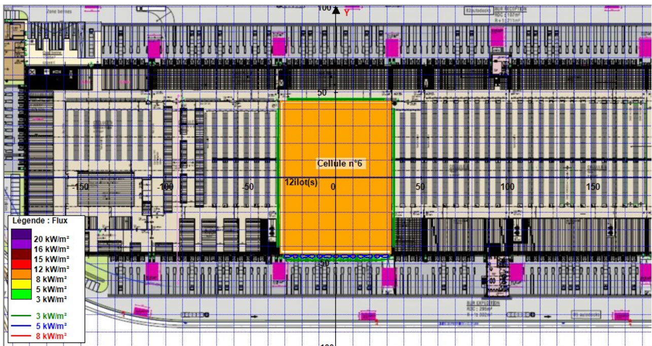
Figure 20 : Cartographie des flux thermiques – cellule 6 (PT1511–masse)
