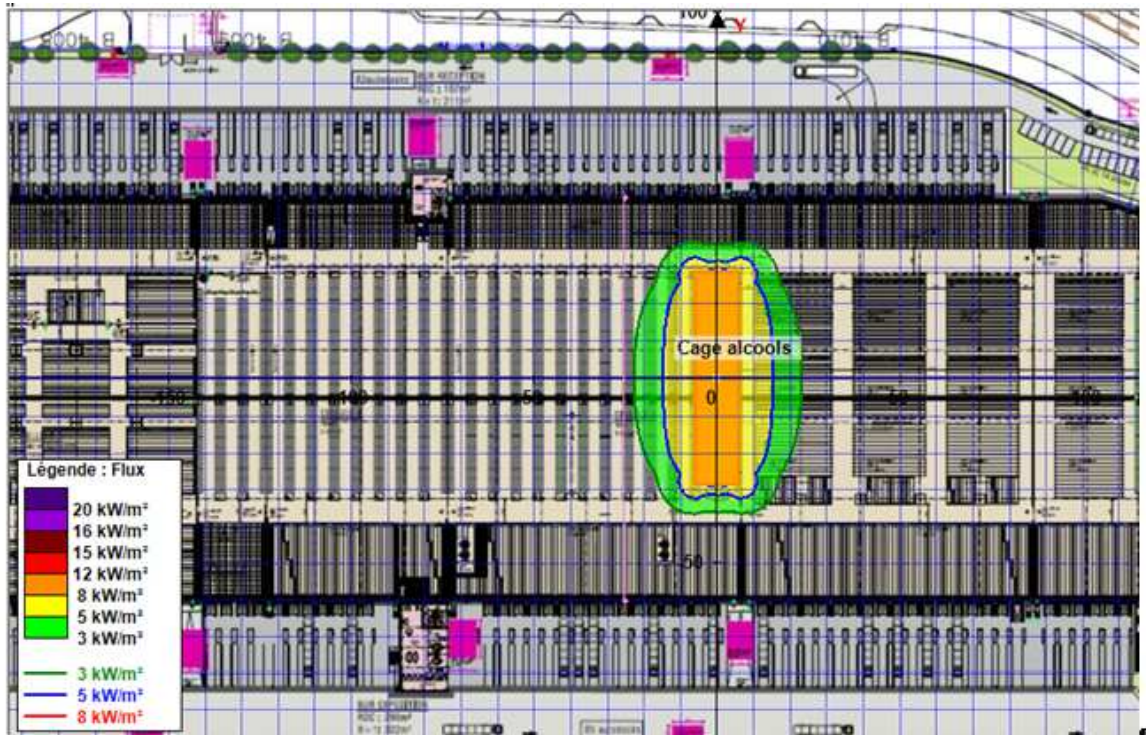
Figure 15 : Cartographie des flux thermiques – cage alcools
