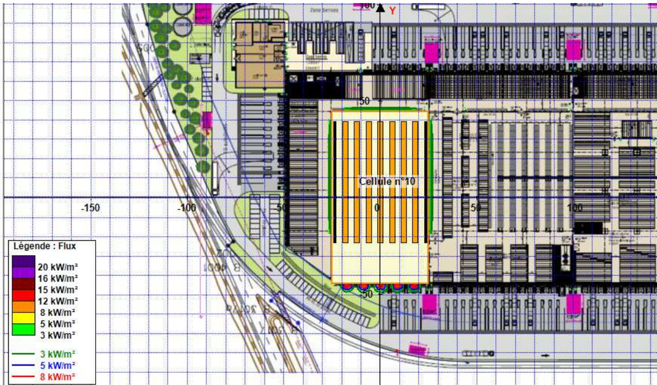
Figure 13 : Cartographie des flux thermiques – cellule 10 (PT1510 - racks)
