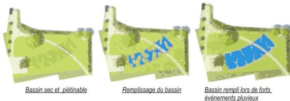
Schéma de principe de la simulation de remplissage du bassin, projet Cité de la Saussaie, 2004 (Saint Denis). (source : Atelier S.Renaudie, LAFFRANCHI E., 10/2005)
