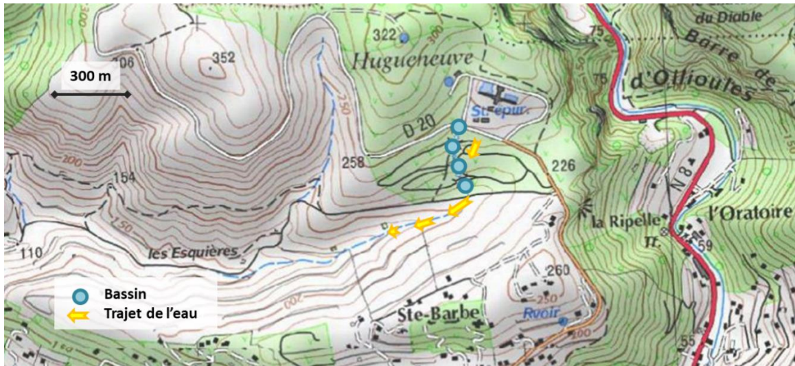
Figure 8 : Schéma du rejet des eaux de nettoyages issues de l'UPEP d'Hugueueuve (scan IGN)
