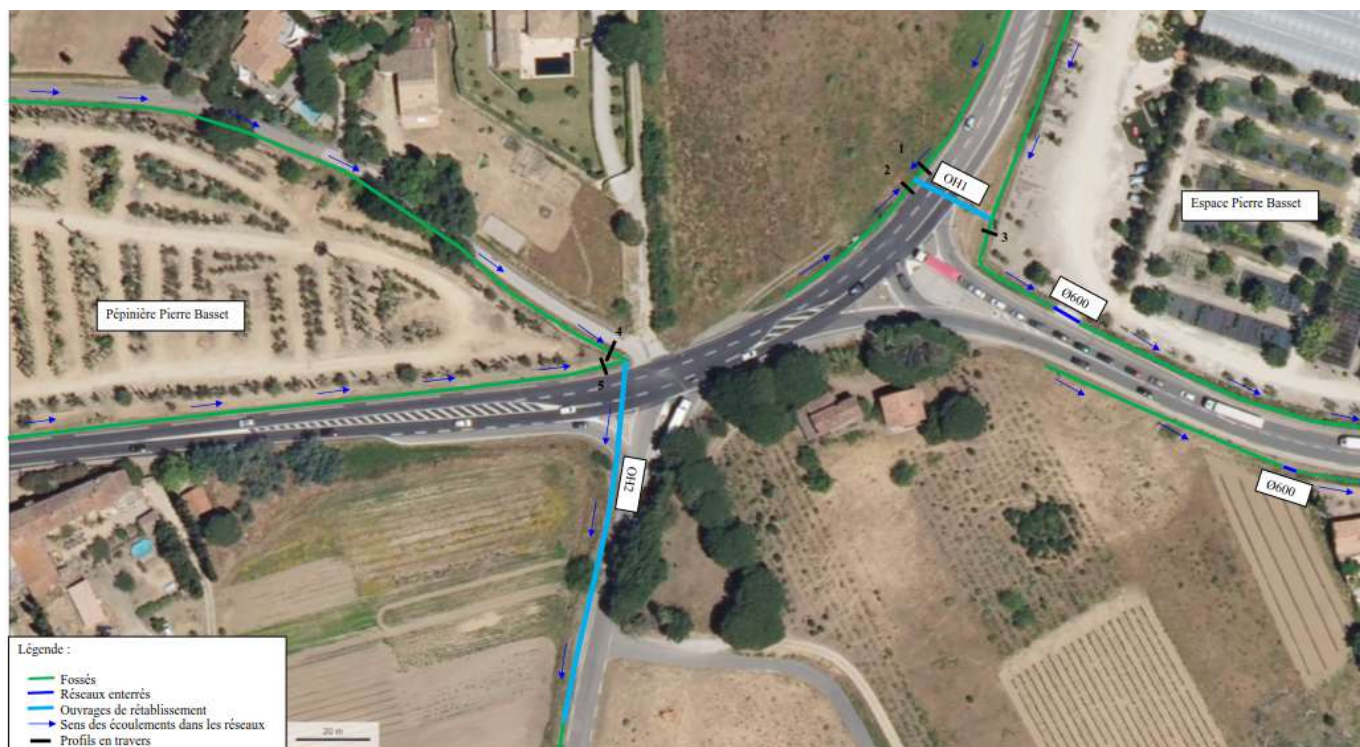
Plan du réseau pluvial
