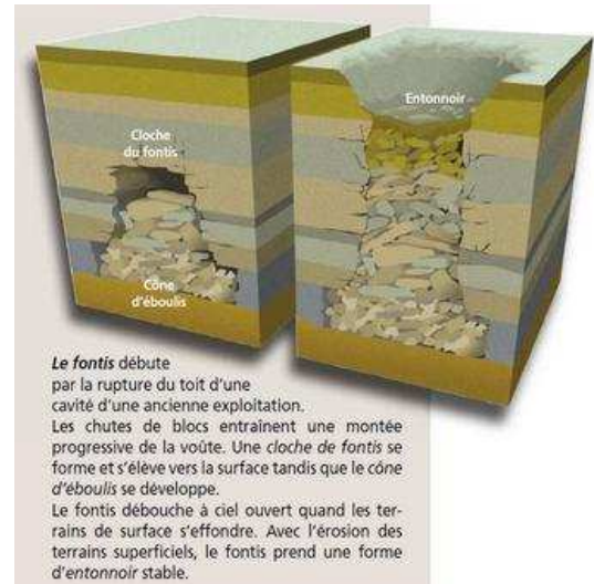
Illustration du phénomène d'effondrement localisé
