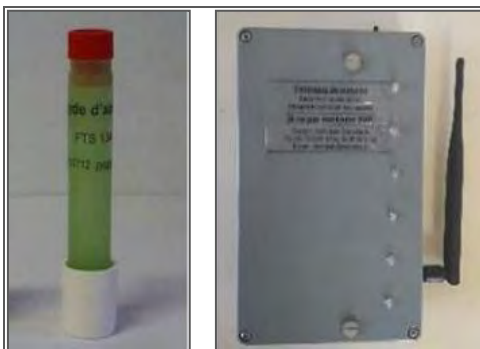
Figure 90 : Tube passif et micro-capteur laser
