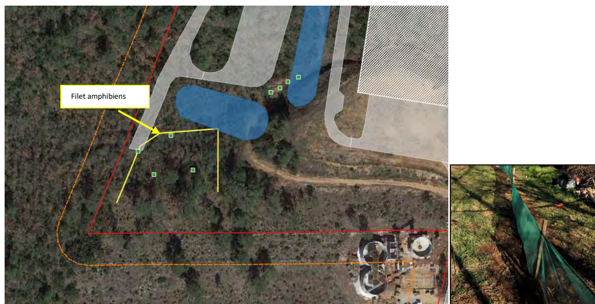
Figure 132 : barrières anti-franchissement pour les amphibiens
