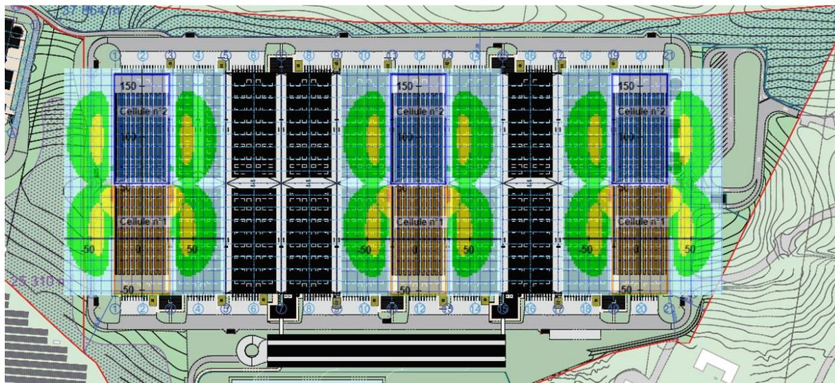
*Matérialisation des flux thermiques sur le bâtiment B – hauteur de cible 1.80m*
