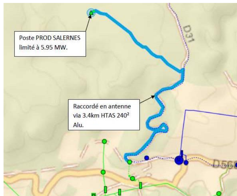
Schéma simplifié indicatif de raccordement – Source ENEDIS
