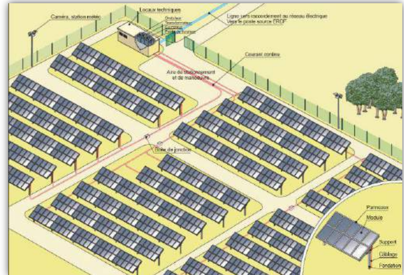
Principe d'implantation d'une centrale solaire (Source : Egis Eau, Guide méthodologique de l'étude d'impact d'une centrale PV au sol, 2011)
