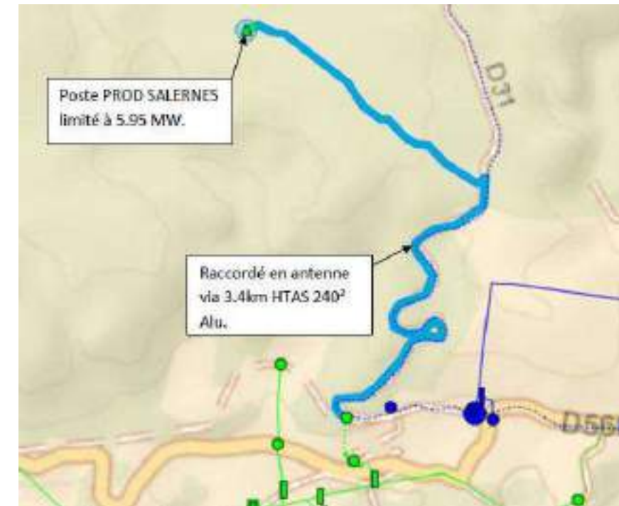
Schéma simplifié indicatif de raccordement – Source ENEDIS
