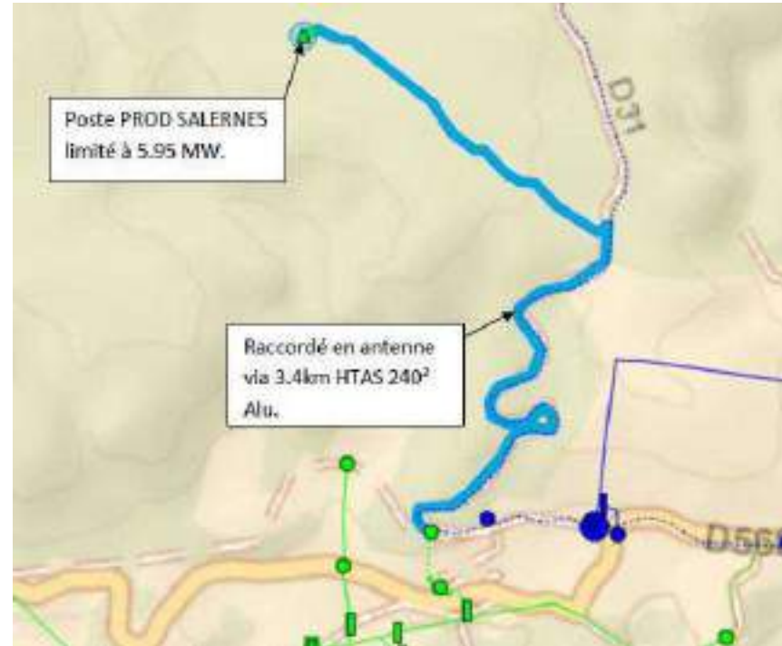
Schéma simplifié indicatif de raccordement – Source ENEDIS
