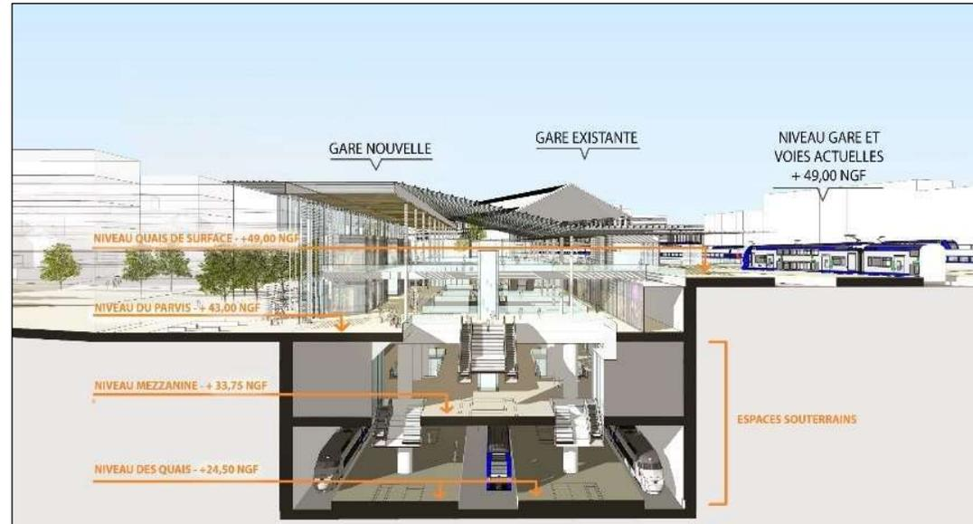
Figure 29 : Les différents niveaux de la gare nouvelle (AREP 2021)
