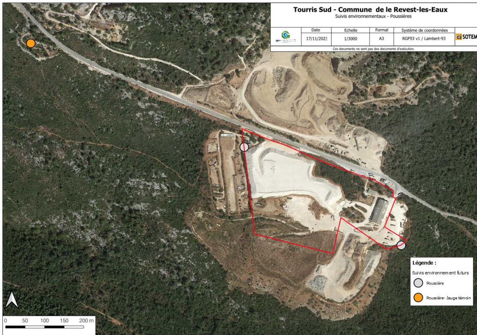
Figure 13. Plan d'implantation estimatif des futures jauges de mesure des poussières
