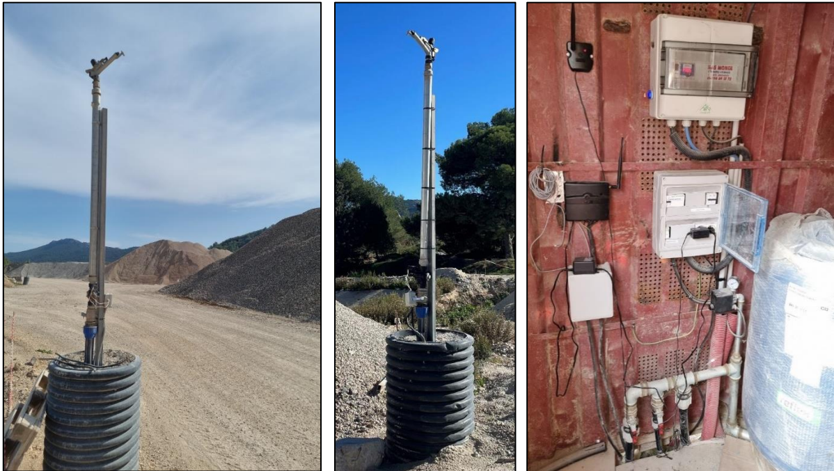
Figure 5. Exemples d'utilisation de l'eau pour l'abattage des poussières par asperseurs
