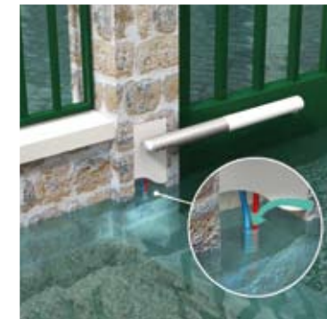
Passage possible de l'eau par les entrées de gaine.
