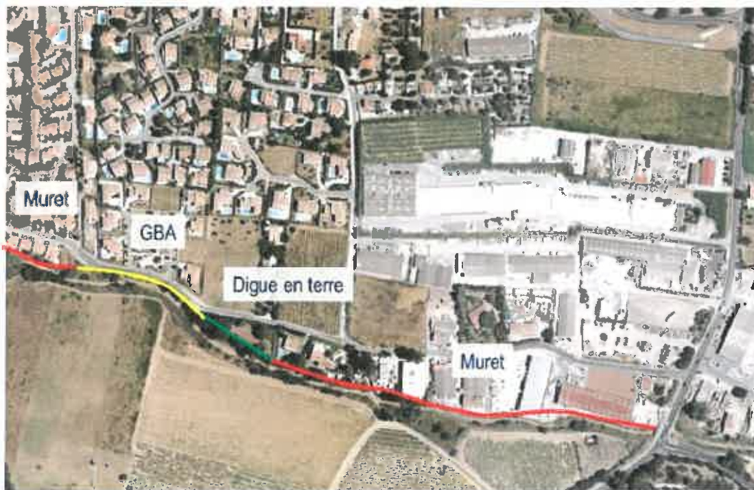
Fig. 7. Type d'ouvrage de protection rive gauche sur la commune de Bormes (2/2)
